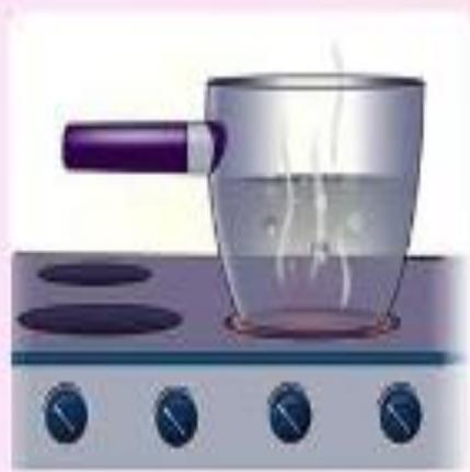
El fuego que se encuentra por debajo calienta el metal de la olla, en este caso el metal es el que permite el paso de calor y se lo transmite al agua que esta dentro de la olla.
