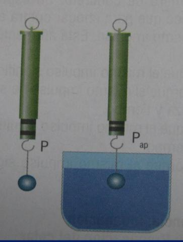
Antes de sumergir el objeto al agua, se mide el peso del objeto con el dinamómetro.
