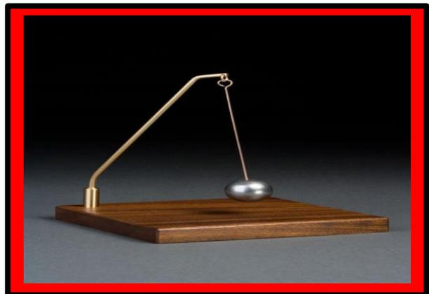
En un péndulo, la fuerza recuperadora es igual a la componente del peso dirigido al punto de equilibrio. El péndulo simple consiste en una masa suspendida de un hilo inextensible, que oscila en forma periódica según como se muestra en la figura.
